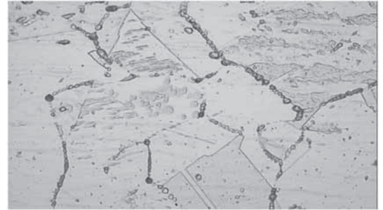
AISI 304 SENSIBILIZZATO MA NON SOLUBILIZZATO: CARBURI DI CROMO AI BORDI DEI GRANI
